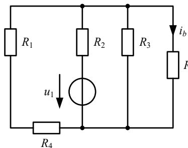
On commence par appliquer l'équivalence *source de tension – source de courant* et par la mise en série des résistances  $R_1$  et  $R_4$  :
