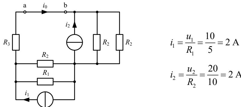
Pour simplifier le circuit, on met en parallèle  $R_1$  avec  $R_2$  et  $R_2$  avec  $R_2$  :
