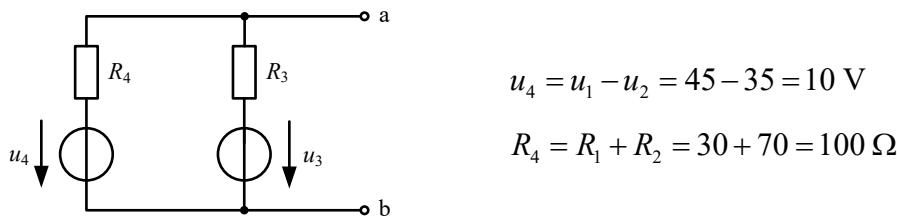
Une deuxième transformation du circuit utilisant l'équivalence *source de tension – source de courant* permet d'obtenir des sources de courant en parallèle :
