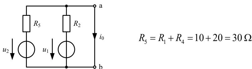
À l'aide de l'équivalence *source de tension – source de courant*, on obtient :
