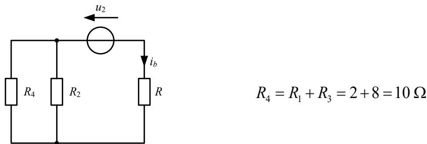
On met en parallèle les résistances  $R_2$  et  $R_4$  :
