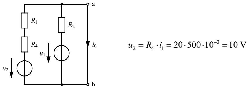
Avec la mise en série des résistances  $R_1$  et  $R_4$ , on obtient le circuit suivant :
