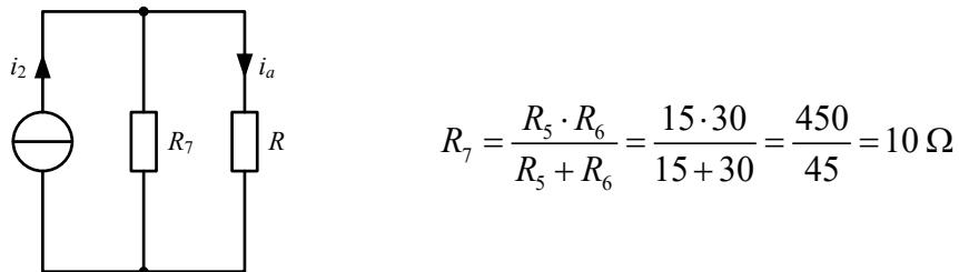
Pour terminer, on calcule le courant  $i_a$  à l'aide d'un diviseur de courant :
