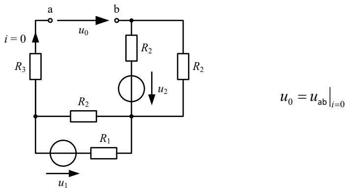
La condition  $i = 0$  permet d'éliminer la résistance  $R_3$ .
