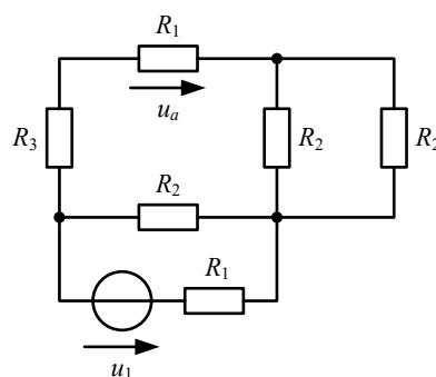
On commence par appliquer l'équivalence *source de tension – source de courant* et par la mise en parallèle des résistances  $R_2$  et  $R_2$  :
