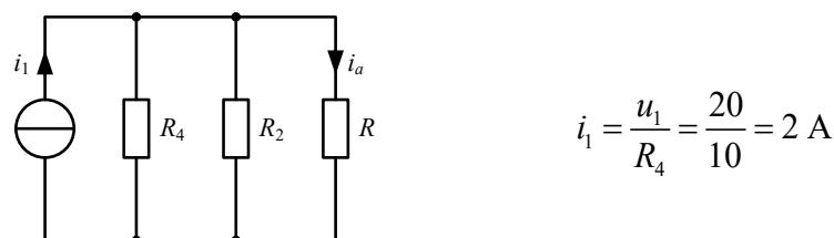
On met en parallèle les résistances  $R_2$  et  $R_4$  :
