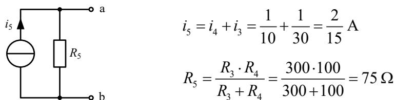
Une dernière transformation du circuit utilise l'équivalence *source de courant – source de tension* et permet d'obtenir la source de tension en série avec la résistance :
