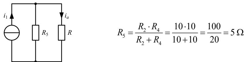
Pour terminer, on calcule le courant  $i_a$  à l'aide du principe du diviseur de courant :
