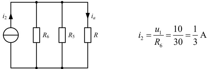
On met en parallèle les résistances  $R_5$  et  $R_6$  :
