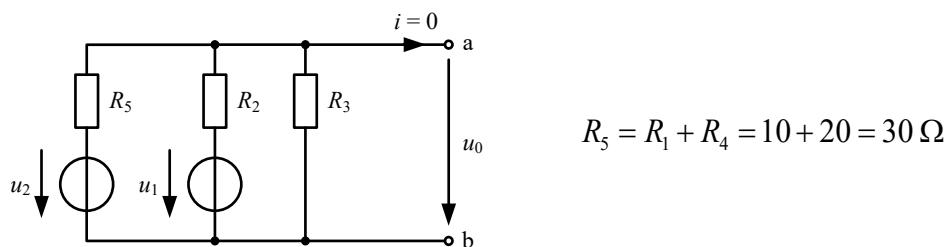
À l'aide de l'équivalence *source de tension – source de courant*, on obtient :
