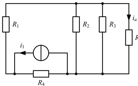
On commence par appliquer l'équivalence *source de courant – source de tension* et par la mise en parallèle des résistances  $R_2$  et  $R_3$  :
