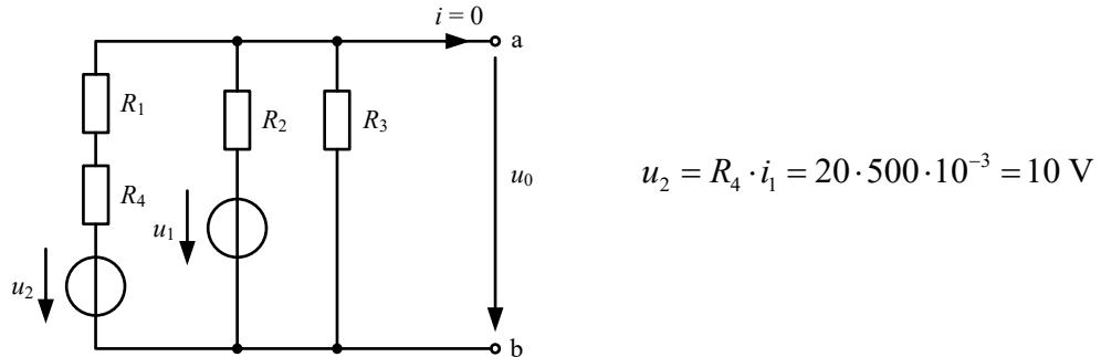
On met en série des résistances  $R_1$  et  $R_4$  :
