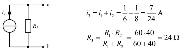
Une dernière transformation du circuit utilise l'équivalence *source de courant – source de tension* et permet d'obtenir la source de tension en série avec la résistance :
