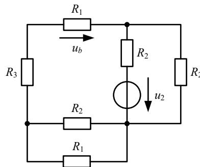
On commence par appliquer l'équivalence *source de tension – source de courant* et par la mise en parallèle des résistances  $R_1$  et  $R_2$  :
