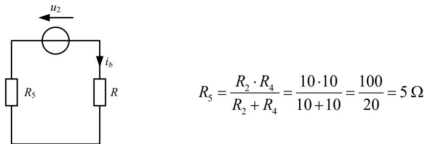
Pour terminer, on calcule le courant  $i_b$  à l'aide de la loi de Ohm :
